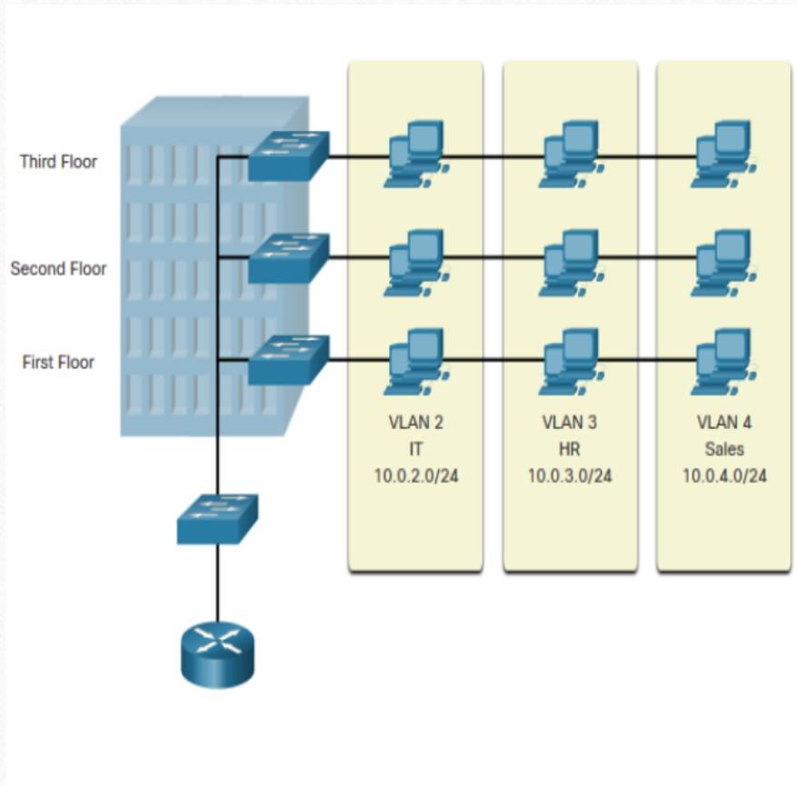
Les VLAN (Virtual Local Area Networks) permettent de diviser un réseau en un ou plusieurs sous-réseaux virtuels.
